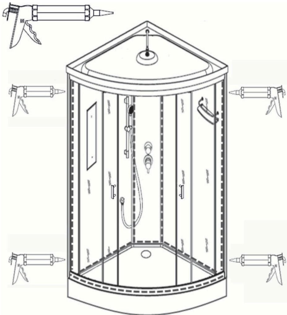
Следуя инструкции по сборке, проверьте все функции кабины. После этого, переместите кабину на место установки. При помощи душа проверьте герметичность швов. При необходимости нанесите небольшое количество герметика по швам соединения.
